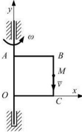
Прямоугольная пластина ABCO вращается равномерно вокруг стороны OA пластины с постоянной угловой скоростью  $\omega = 2 \ pao/c$ . По стороне BC пластины движется материальная точка M по закону BM = 3t.
