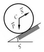
На наклонной плоскости под действием приложенных сил покоится цилиндрический каток. Радиус катка — 0,5 M, масса катка — 100 K2, коэффициент трения скольжения f — 0,15, коэффициент трения качения  $\frac{\delta - 0,05}{S}$  см. Угол между плоскостью и горизонтом равен  $5\square$ . Максимальное значение силы  $\frac{\overline{S}}{S}$ , при котором каток находится в покое, равно \_\_\_\_\_ H.
