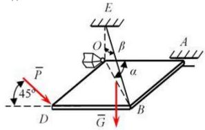
Прямоугольная плита весом  $G=15~\kappa H$  удерживается в горизонтальном положении сферическим шарниром O, подшипником A и тросом BE, причем точки O и E находятся на одной вертикали. В точке D к плите приложена сила  $P=5~\kappa H$ , перпендикулярная к стороне OD и наклоненная к плоскости плиты под углом  $45^\circ$ .  $\alpha=\beta=30^\circ$  и и |OA|=2|OD/. Горизонтальная составляющая реакции в опоре A по модулю равна \_\_\_\_ ( $\kappa H$ ).
