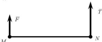
Перпендикулярно к отрезку MN приложены две параллельные силы: F=3~H и T=5~H. |MN|=2~m. Укажите модуль и точку приложения равнодействующей т. C.
