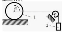
Механическая система состоит из катка 1, невесомого блока и груза 2, соединенных невесомой нерастяжимой нитью (см. рис.). Масса катка  $m_1 = 3 \, \kappa \varepsilon$ , масса груза  $m_2 = 4 \, \kappa \varepsilon$ , радиус катка 0,5 м. Каток катится по горизонтальной поверхности с угловой скоростью  $\omega = 2 \, pa \partial/c$ . Количество движения системы равно \_\_\_  $\kappa \varepsilon \Box m/c$ .
