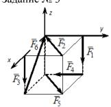
По граням и ребрам куба действуют 6 равных по модулю сил  $\overline{F}_k$ . Главный вектор системы сил (геометрическая сумма всех сил)  $\overline{R}$  по модулю равен ...
