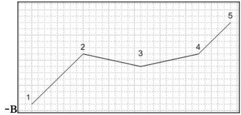
33. Разомкнутый теодолитный ход изображён под буквой: а б в(ОК 03, ПК 3.3)
