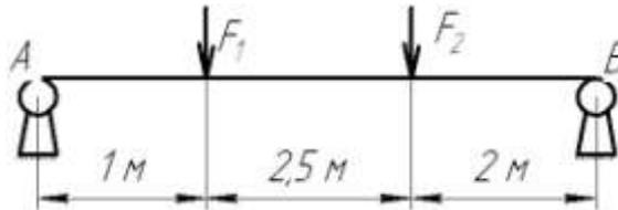
1. Определить реакции опор балки. Дано:  $F_1 = 10$  кН,  $T = 40$  кН,  $q = 0,8$  кН/м. (ОК 01, ОК 02, ОК 09.)
