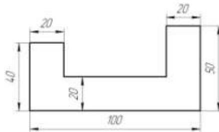
3. На стальной ступенчатый брус действуют силы  $P = 20$  кН и  $T = 30$  кН.  $A_1 = 400$  мм<sup>2</sup>,  $A_2 = 800$  мм<sup>2</sup>,  $a = 0,2$ . Построить эпюру нормальных сил. (ОК 01, ОК 02, ОК 09.)
